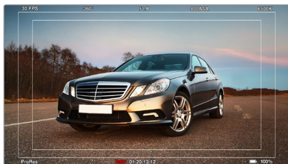
外接显示器上设置的SDI / HDMI叠加
